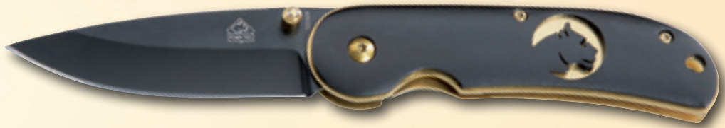
PUMA TEC Einhandmesser (Art.-Nr.: 7302411) Klingenlänge: 78 mm · Klingenstahl: AISI 420 Länge geschlossen: 110 mm · Gewicht: 166 g Schale: Aluminium mit Puma-Motiv, Clip
